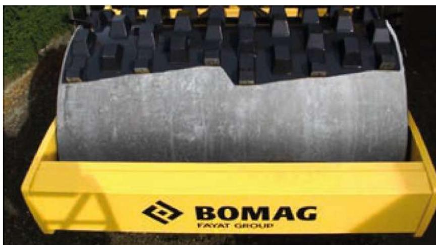
Os modelos da série D são adequados para compactar materiais não coesivos; solos (areia, cascalho, entulho), solos fracamente coesos e materiais ligados hidraulicamente.
